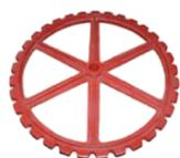
Звездочка приводная, ролик натяжной для соломоловушки.
