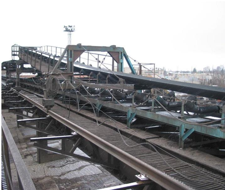
Завод «ЭЛМЗ» проектирует, производит и реализует ленточные транспортеры, предназначенные для перемещения сыпучих, кусковых, штучных грузов в горизонтальном и наклонном положении на расстояния достигающих от 2 до 200м и больше в сельском хозяйстве, на сахарных заводах, в строительной индустрии, на базах и т.д.
